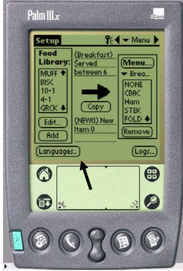
Şekil 1: Ok sıcaklık ve dil ekranının değiştirilebileceği Dil düğmesini göstermektedir.
